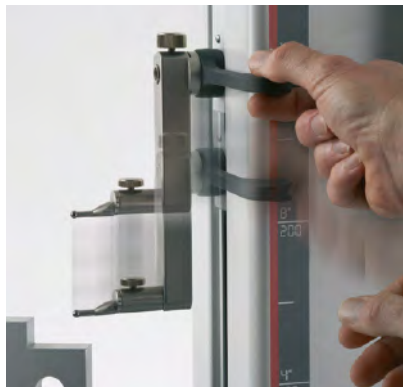
Rysunek 1. Przesuń ręką ramię pozycjonującą w kierunku obiektu pomiarowego.
