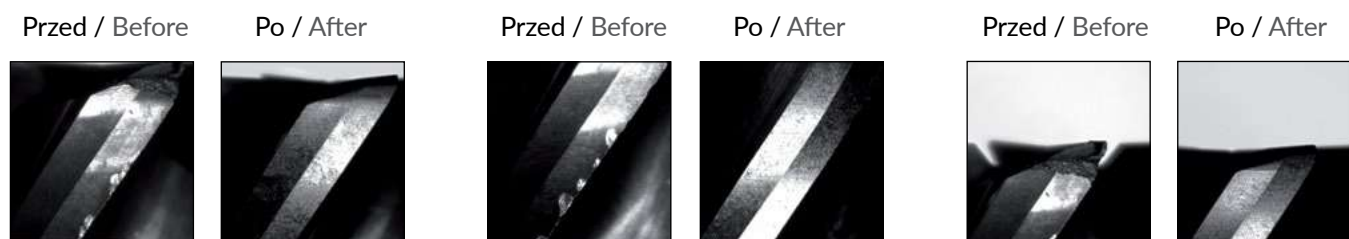
Krawędź skrawająca w powiększeniu x 20 (zdjęcie z maszyny Zoller) Cutting edge in magnification 20x (photo from Zoller machine)
