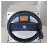
▶ Obsługa maszyny z przodu za pomocą pokręta z licznikiem
