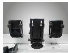
Uchwyty mocujące z długimi prowadnicami do różnych wysokości detali
