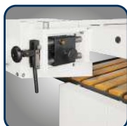
Szybkie napięcie taśmy umożliwia szybkie i bezproblemowe wymienianie taśm szlifierskich.
