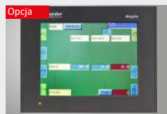
Opcjonalny sterownik Schneider TM 238, sterownik jednoosiowy do cyfrowego wprowadzania kąta na dużym ekranie dotykowym z możliwością zapisywania sekwencji fazowania
