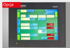
Opcjonalny sterownik Schneider CNC3A, sterownik trójosiowy do cyfrowego wprowadzania kąta, wprowadzania pozycji ogranicznika tylnego i pozycji otworu lica z możliwością zapisywania sekwencji fazowania, silnikowy ogranicznik tylny z palcami oporowymi, zakres przemieszczania 15-1000 mm
