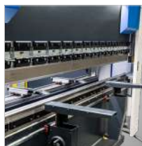
▶ Szybko regulowane przednie ramiona podporowe
