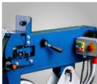
Naciąg taśmy za pomocą dźwigni
