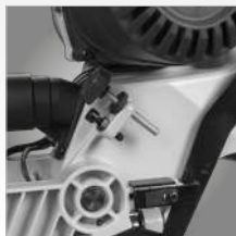
Dwustopniowy ogranicznik głębokości cięcia
