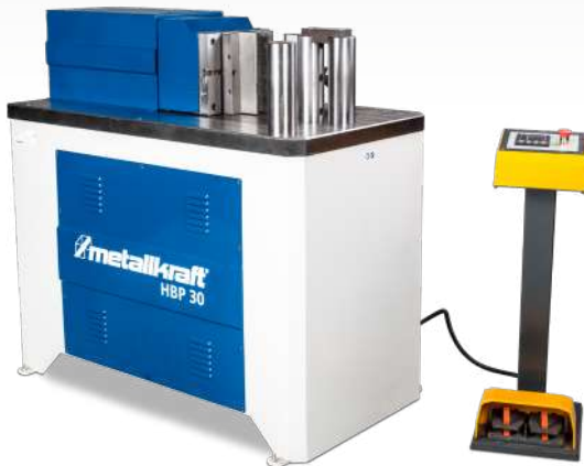
▶ Panel sterowania z wyświetlaczem cyfrowym i wyłącznikiem awaryjnym
