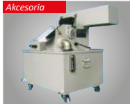
Oddzielnik magnetyczny i system chłodzący
