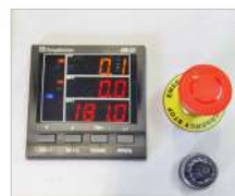
▶ Prosta obsługa, z cyfrowym wyświetlaczem dla bieżących wartości gięcia i do ustawiania parametrów
