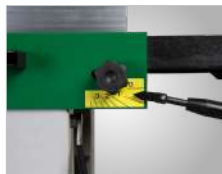
Przewstawienie grubości wióra za pomocą dźwigni obsługowej
