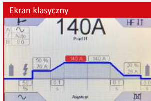
Łatwe i szybkie zapisywanie czterech aktualnych programów spawalniczych
