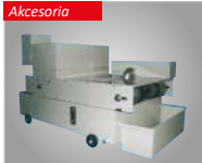
Automatyczny papierowy filtr taśmowy i system chłodzący
