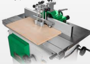
Uchwyt dolny do precyzyjnego prowadzenia obrabianego przedmiotu
