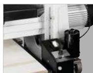
Regulacja wysokości zespołu szlifierskiego czytelna na skali
