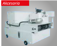
Automatyczny papierowy filtr taśmowy z oddzielnikiem magnetycznym i systemem chłodzącym
