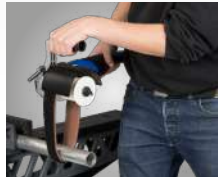
▶ Satynowanie stali okrągłej włókniną na rzep także np. w przypadku już zamontowanych poręczy ze stali szlachetnej
