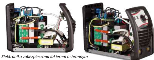
Elektronika zabezpieczona lakierem ochronnym
