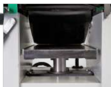
Regulacja stołu grubościówki poprzez pokrętło ręczne, skalę i wyświetlacz numeryczny
