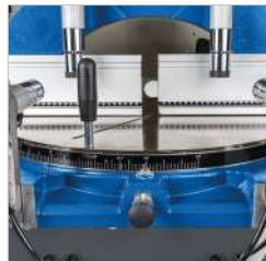
Bezstopniowa regulacja kąta cięcia
