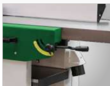
Przestawienie grubości wióra za pomocą dźwigni obsługowej
