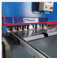
▶ Składana osłona palców 1000 mm z oknem wzornikowym
