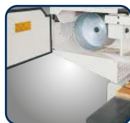
Odpowiednio wyważone rolki zapewnią optymalny napęd taśmy
