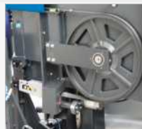
• Napędzana elektrycznie szczotka do usuwania wiórów
