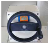
▶ Obsługa maszyny z przodu za pomocą pokrętła z licznikiem
