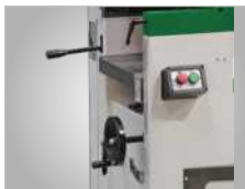
Regulacja stołu grubościówki poprzez pokrętko ręczne
