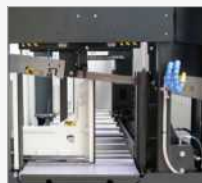
• Pochylenie taśmy tnącej o 7° i hydrauliczne napinanie taśmy tnącej zwiększają jej żywotność.
