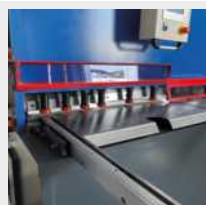
▶ Składana osłona palców 1000 mm z oknem wziernikowym
