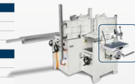
Opcja: Suport wiertarski Uchwyt wiertarski 16 mm Wymiary stołu: 470 x 230 mm Suw: X x Y x Z= 160 x 120 x 110 mm Z dźwignią sterowniczą, nr art.: 5510379
