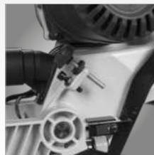
Dwustopniowy ogranicznik głębokości cięcia
