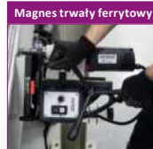
Magnes trwały ferrytowy Magnes trwały Niezależny od prądu magnes stały w 100% bezpieczny przy zaniku napięcia
