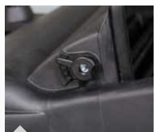
· Prosta i beznarzędziowa regulacja wysokości walca zmiatającego
