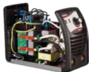
Elektronika zabezpieczona lakierem ochronnym
