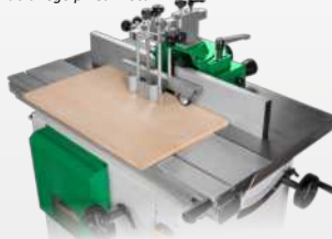
Uchwyt dolny do precyzyjnego prowadzenia obrabianego przedmiotu
