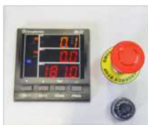
▶ Prosta obsługa, z cyfrowym wyświetlaczem dla bieżących wartości gięcia i do ustawiania parametrów
