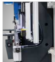
▶ CNC-sterowanie, hydrauliczne wyoblanie stołu
