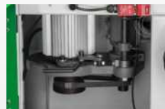
Szybka i łatwa zmiana prędkości za pomocą wielowypustowych pasków
