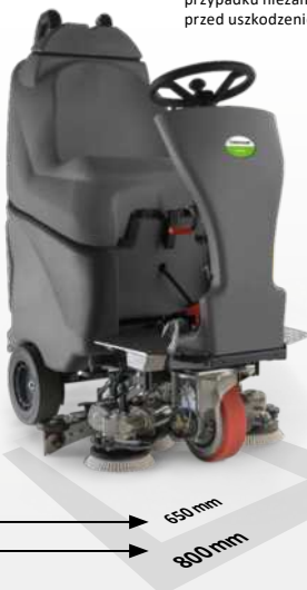
Cztery małe szczotki tarczowe, z bezpośrednio umieszczoną za nimi listwą zasysającą.
