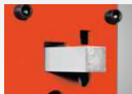
▶ Nożyce do prętów o przekroju kwadratowym
