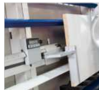
▶ Cyfrowy wyświetlacz wymiaru dla cięcia pionowego (wersja "ED")
