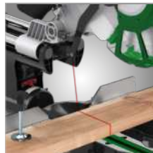
Laser wskazujący idealną linię cięcia
