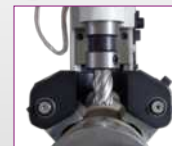
Dwa magnesy indywidualnie przełączane. Pozwala to na odchylenie maszyny w celu sprawdzenia lub oczyszczenia otworu bez utraty jego pozycji na rurze
