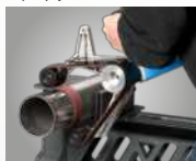
▶ Tylko dwa kroki robocze potrzebne do szlifowania obwodowego 360°
