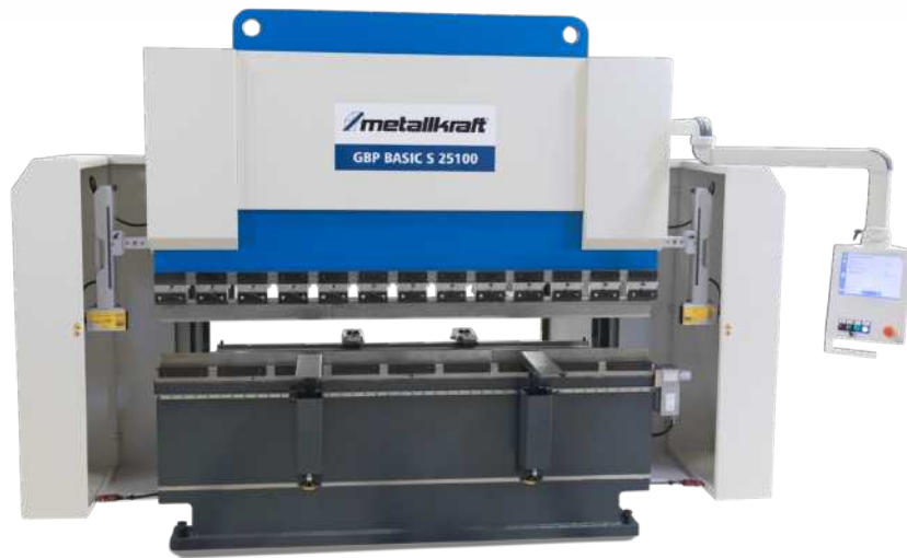
▶ CNC-sterowanie, hydrauliczne wyoblanie stołu
