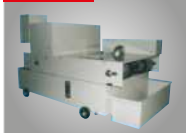
Automatyczny papierowy filtr taśmowy i system chłodzący
