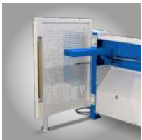
▶ Tylna przestrzeń robocza zabezpieczona kurtyną świetlną
