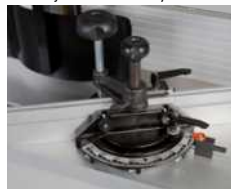
Bezstopniowa regulacja ogranicznika kąтового
