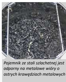
Z sitem olejowym na wióry metalowe i emulsję olejową
