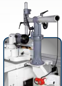
Opcja Odchylane ramię z przyłączem elektrycznym do zamontowania aparatu posuwowego
