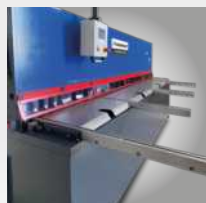
▶ Kulki w stole podporowym dla lepszej obsługi arkuszy ▶ Ogranicznik boczny 1500mm z podziałką i rowkiem teowym
