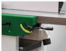
Przestawienie grubości wióra za pomocą dźwigni obsługowej
