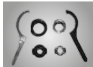
Różne noże do profili stalowych, siadła do wytlaczania i specjalne stemple i matryce dostępne na zamówienie
