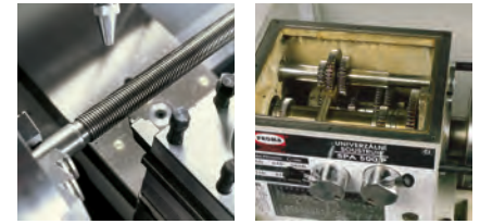
WSZYSTKIE RUCHOME ELEMENTY PRZEKŁADNI PRACUJĄ W KĄPIELI OLEJOWEJ
