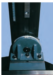
FREZARKĘ MOŻNA USTAWIĆ POD KĄTEM ± 45° W PŁASZCZYŹNIE PODŁUŻNEJ STOŁU
