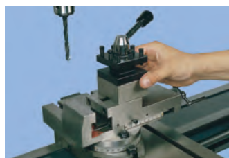
PO ZDEMONTOWANIU IMAKA MAMY DO DYSPOZYCJI IMADŁO
