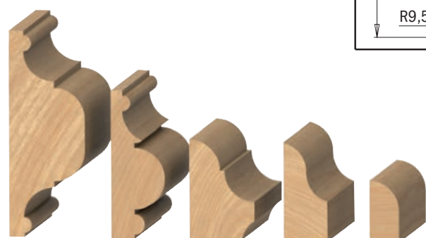
4 przejścia 3 przejścia 3 przejścia 2 przejścia 1 przejście
