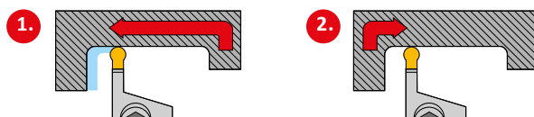
Obróbka wykańczająca zagłębienia (płytkka z okrągłym ostrzem)
