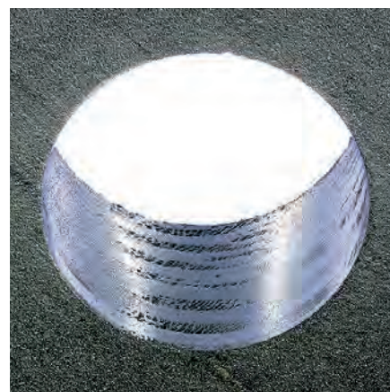
Otwór D = 6,35 mm Kompozyt CFRP z włóknami wielokierunkowymi, optymalna jakość otworu
